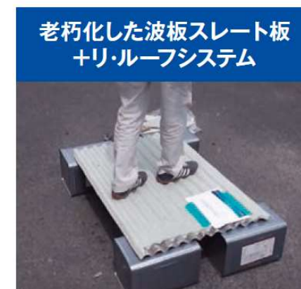
老朽化した波板スレート板 + リ・ルーフシステム 両足が乗っても破損せずまた、屈伸しても破損せず
