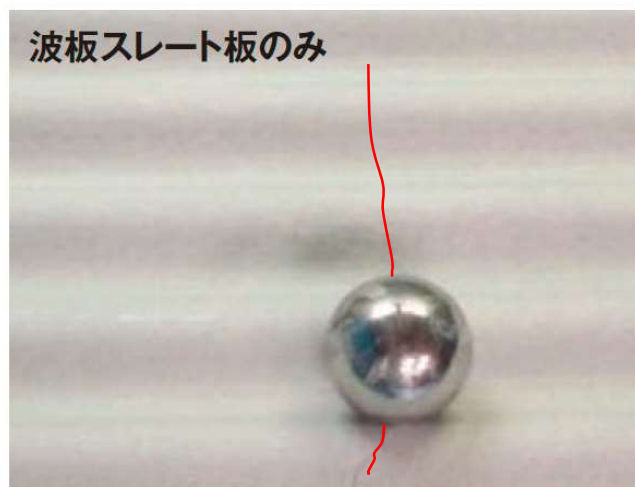
波板スレート板のみ ひび割れ発生
