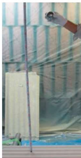
波板スレート板のみ ひび割れ発生
