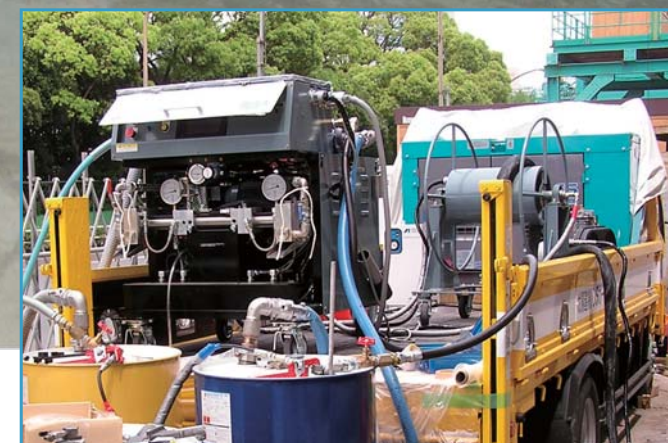
ポリウレア樹脂 スプレー施工システム車両 (例) (ホース延長90m)
