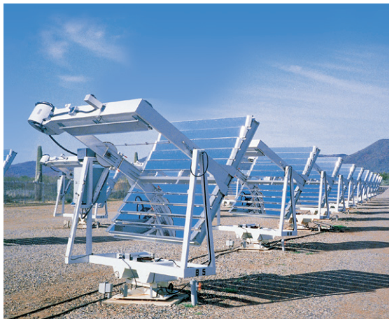
屋外促進暴露試験(エマキュア試験)
