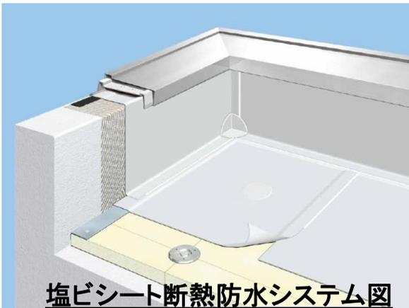
塩ビシート断熱防水システム図
